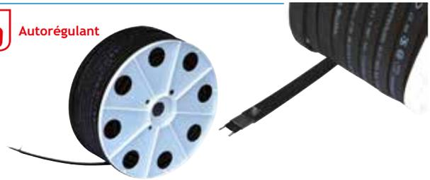
Le ruban chauffant permet la mise hors gel des installations d'eau avec tuyauteries métalliques ou PE non protégées. Il est réalisé à partir de deux fils conducteurs d'électricité entourés d'un isolant chargé de particules de graphite conductrices.
