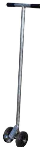
Chariot métallique galvanisé équipé d'une poignée en partie haute et d'un pivot monté sur deux roues en partie basse. Le pivot se positionne au centre à l'avant des cases dans un support prévu à cet effet. Grâce au phénomène de levier, il est alors aisé de déplacer sans effort les boxes roulants sur un sol plat.
