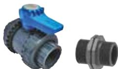
Vanne femelle/femelle 1/4 de tour livrée avec un raccord union mâle/mâle à visser. Elle se positionne dans le second insert inox non débouchant situé sur l'une des 3 faces planes en partie basse de la cuve. Fond de l'insert, obstrué par le polyéthylène, à percer à la scie cloche par l'utilisateur pour la mise en place de l'embout droit.
