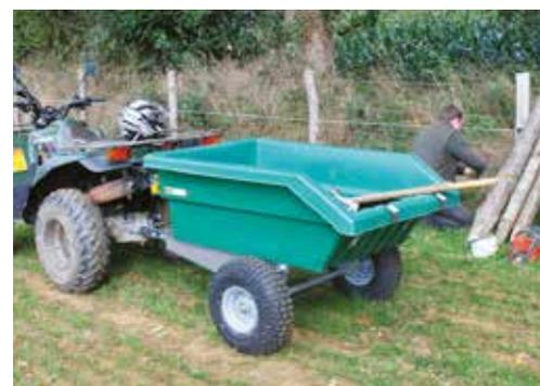
Cuve en polyéthylène avec système de blocage anti-basculement avant et renfort métallique de cuve arrière.
