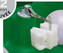
Robinetterie 72 L/min. (débit mesuré à 3 bar) avec épingle d'arrêt (pour le nettoyage). Niveau d'eau réglable sur 5 cm, sans outil.
