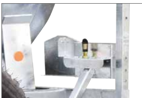
Câblage protégé. Prise gyrophares arrière.
