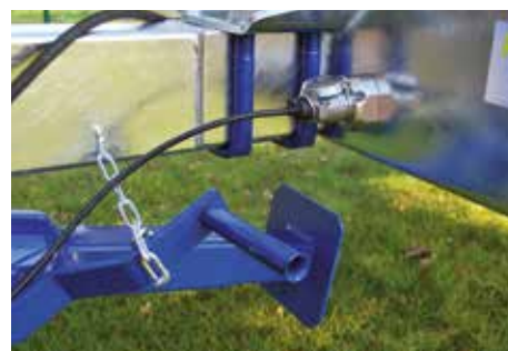
Rallonge électrique du châssis au tracteur (fournie), évitant la détérioration du faisceau par les animaux. Connexion des feux arrière avec passage de fil directement dans le châssis.
