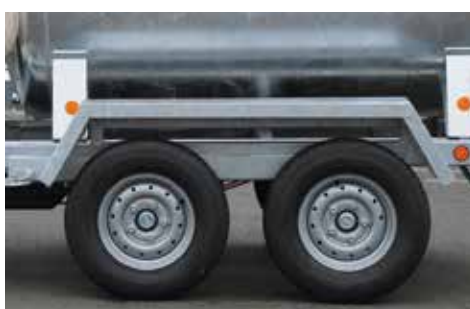
Double essieux pour les modèles 2000 litres avec garde-boue tôlé.
