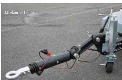
Attelage articulé équipé d'une tête d'attelage à freinage par inertie sur les modèles 2000 litres.
