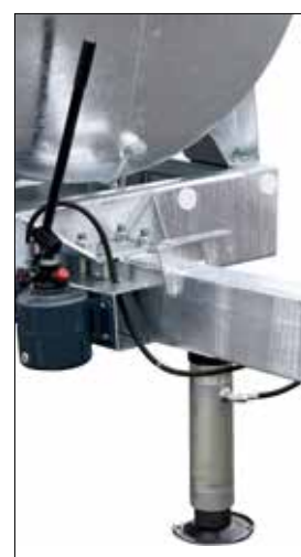
Béquille hydraulique avec pompe et réserve d'origine pour le modèle 8000 L. Ensemble équipé d'une vanne 1/4 de tour et de prises push-pull permettant de démonter le flexible lorsque la citerne reste au champ.
