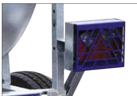
Feux protégés par grille métallique.
