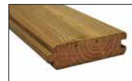
Clin rainuré et bouveté en douglas Autoclave Classe III ép. 42 mm x larg. 145 mm (135 mm utile)
