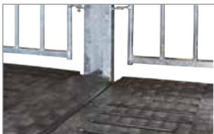
Extrémité de la réglette prévue pour s'encaster parfaitement dans les poteaux PE en lieu et place des cloisons PE limitant le risque de passage des sabots des veaux.
