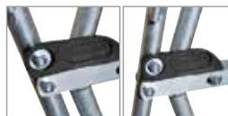
Système "ressort élastique monobranch" breveté réglable sur crémaillère, permet un retour automatique en position ouverte des barres mobiles. L'axe de barre mobile équipée d'une bague de renfort limite l'usure à long terme. Le ressort élastique monobranch est protégé des veaux.
