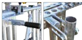
Poignée de réglage d'encolure escamotable. Réglage possible des encolures en simultané de l'ensemble des places.
