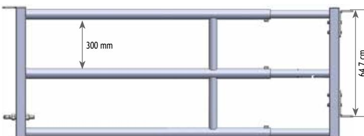
Livré d'origine avec 2 plats de fixation à boulonner sur le montant avant du panneau pré-percé pour les recevoir à l'entraxe de 56,1 cm.
