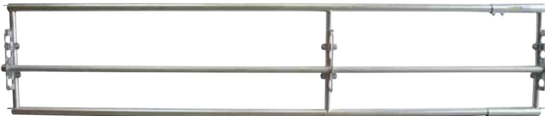
Panneau équipé d'une lisse centrale de Ø 60,3 mm ajustable dans la hauteur grâce au système de brides à réglage rapide équipant les 3 montants verticaux. Hauteur de pose identique aux panneaux d'alimentation et cornadis.
