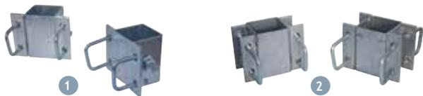
Ces brides sont prévues pour être fixées sur les poteaux en Ø 80 mm. Les étriers sont prévus pour recevoir les poutres en Ø 60 mm qui servent de fixation pour les bat-flancs de logette. Les brides simples permettent une installation simple rangée et les brides doubles une installation double rangées. Voir schéma page 74
