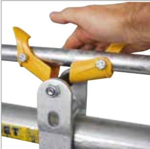
Double taquets polymère embarqués, à ouverture rapide. Permet un blocage des barres mobiles, efficace et silencieux grâce à une entretoise en Téflon de gros diamètre.
