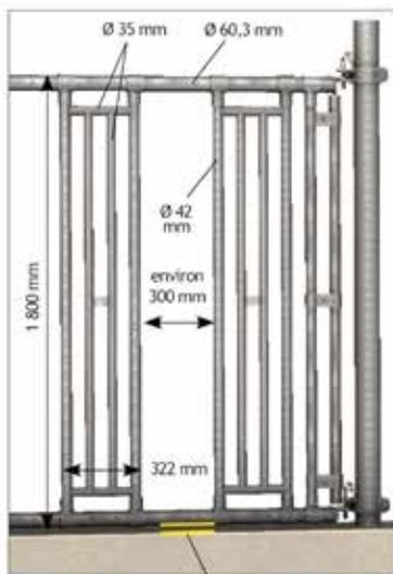
Hauteur de pose au sol : mini. 150 mm/maxi. 195 mm
