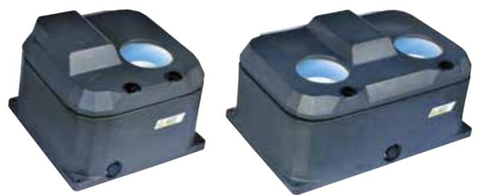
Le Polytherme à coupelle est disponible en version 1 ou 2 coupelles en fonte d'aluminium. Cette dernière est posée dans une goulotte rotomoulée fixée sous le couvercle. Elle affleure l'eau contenue dans le bac et passe à travers 4 trous afin d'être accessible. Le niveau d'eau est continuellement régulé par le mécanisme à niveau constant La Gée 32 l / mn en raccord 1/2". La coupelle peut être enlevée à tout moment en la tournant d'un quart de tour afin de nettoyer les éventuels résidus.
