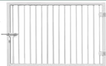
Armature métallique galvanisée à chaud après fabrication. Espace entre les barreaux 60 mm. Tubes 20,5 mm. Fermeture par verrou d'écurie Ø 18 mm. Peut être fixée à l'aide de gonds à sceller ou à boulonner. Livrée sans gâche et sans gond. Options : gâche (P1235704), gond à sceller (P1235701) et gond à boulonner (P1235702). Compatible avec l'hubriserie STANDARD.
