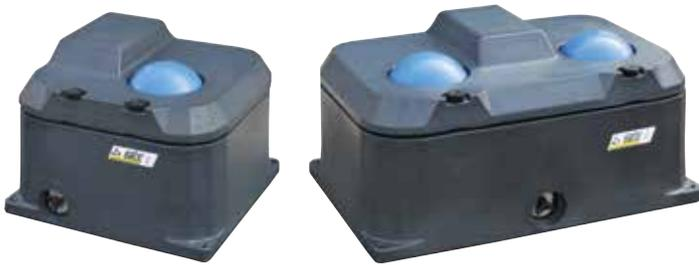
Le Polytherme à boule est disponible en version 1 ou 2 boules. Cette dernière flotte sur l'eau contenue dans le bac toujours régulée par le mécanisme à niveau constant La Gée 32 l/mn en raccord 1/2". Quand l'animal appuie sur la boule, elle s'escamote sous le couvercle grâce à une forme prévue à cet effet. Après l'abreuvement, elle revient en place toute seule et ferme le point d'eau afin de le rendre isotherme.
