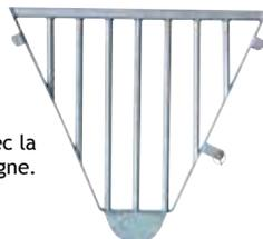
Réalisée en tubes de 21 mm assemblés par mécano-soudure et galvanisés à chaud après fabrication. Fixation par goupille. Compatible avec la porte un battant et la porte coulissante col de cygne. Ne s'adapte pas sur la grille (P1235101).
