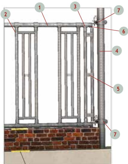
Hauteur de pose avec soubassement : mini. 150 mm/maxi. 495 mm
